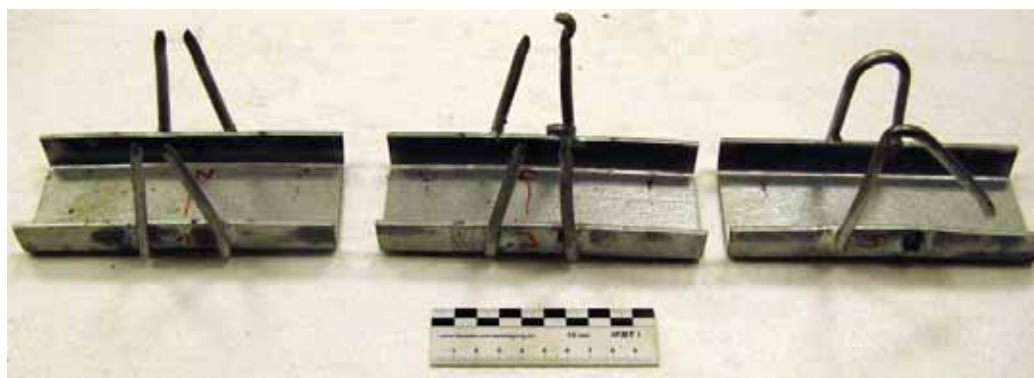
Bild 02 Ankerschienen BGWTU-D aus feuerverzinktem Stahl
