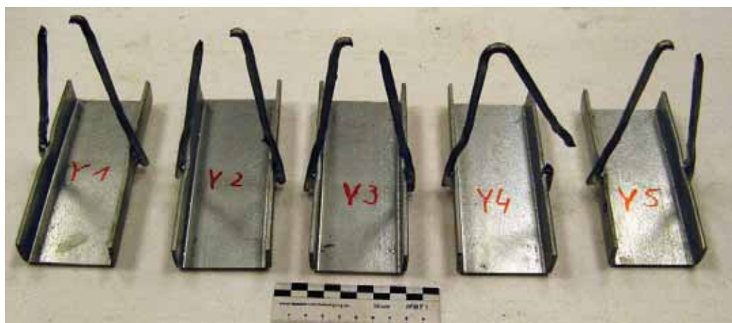
Bild 01 Ankerschienen BGWTU-A aus feuerverzinktem Stahl
